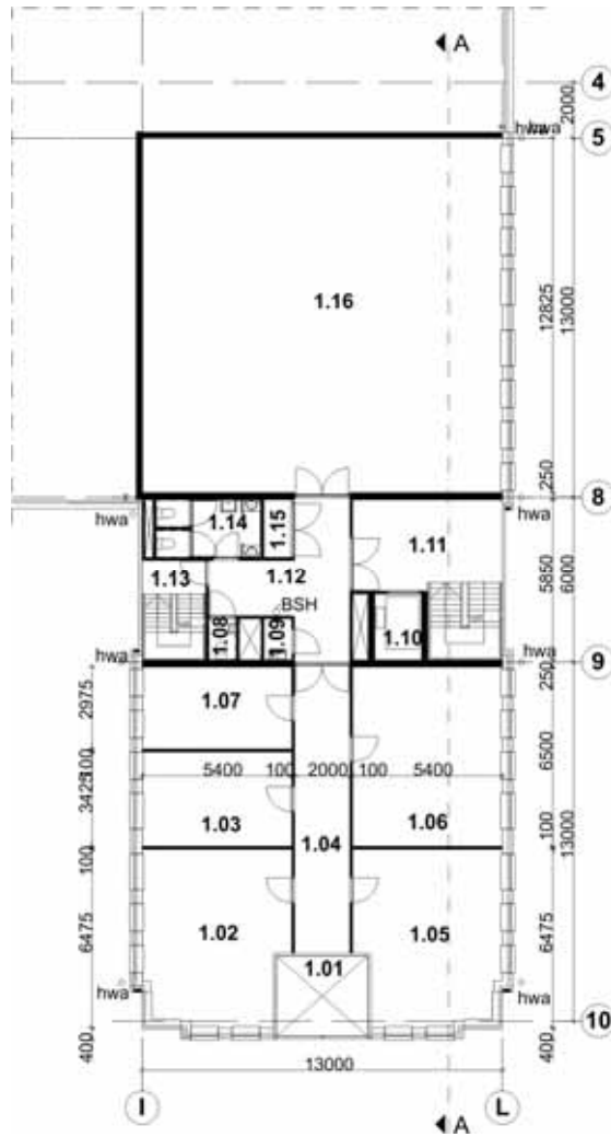
figuur 93 - Eerste verdieping van bouwplan 3 (schaal 1:300)
