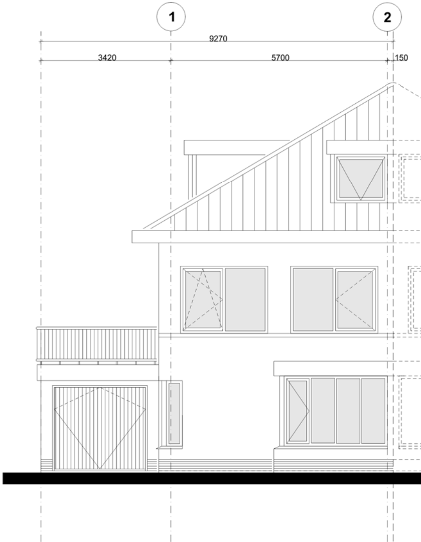
figuur 75 Voorgevel van bouwplan 2 (schaal 1:100)
