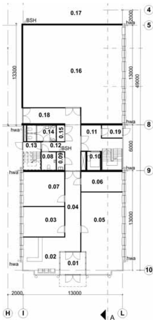
figuur 92 - Begane grond kantoor van bouwplan 3 (schaal 1:300)
